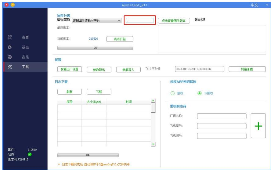
8、输入提取码后，在点击升级，就可以升级到特定的固件；
